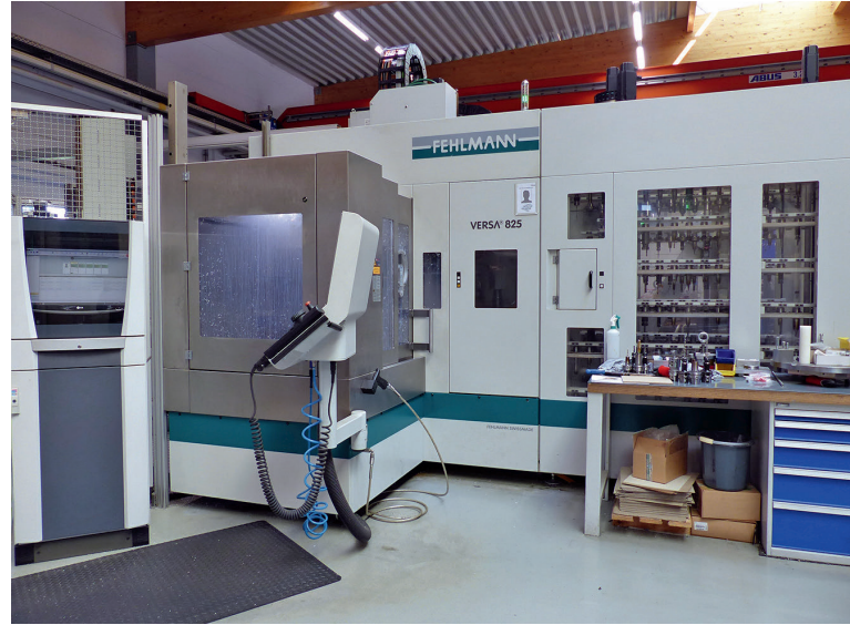
5 Versa 825 mit Automation im Dauerbetrieb: Nach fast 10 Jahren und 8000 Spindelstunden im Jahr hat man die Geometrie vermessen. Ohne elektronische Nachregelung liegt man in allen Achsen im Bereich von 2 µm © Fehlmann
